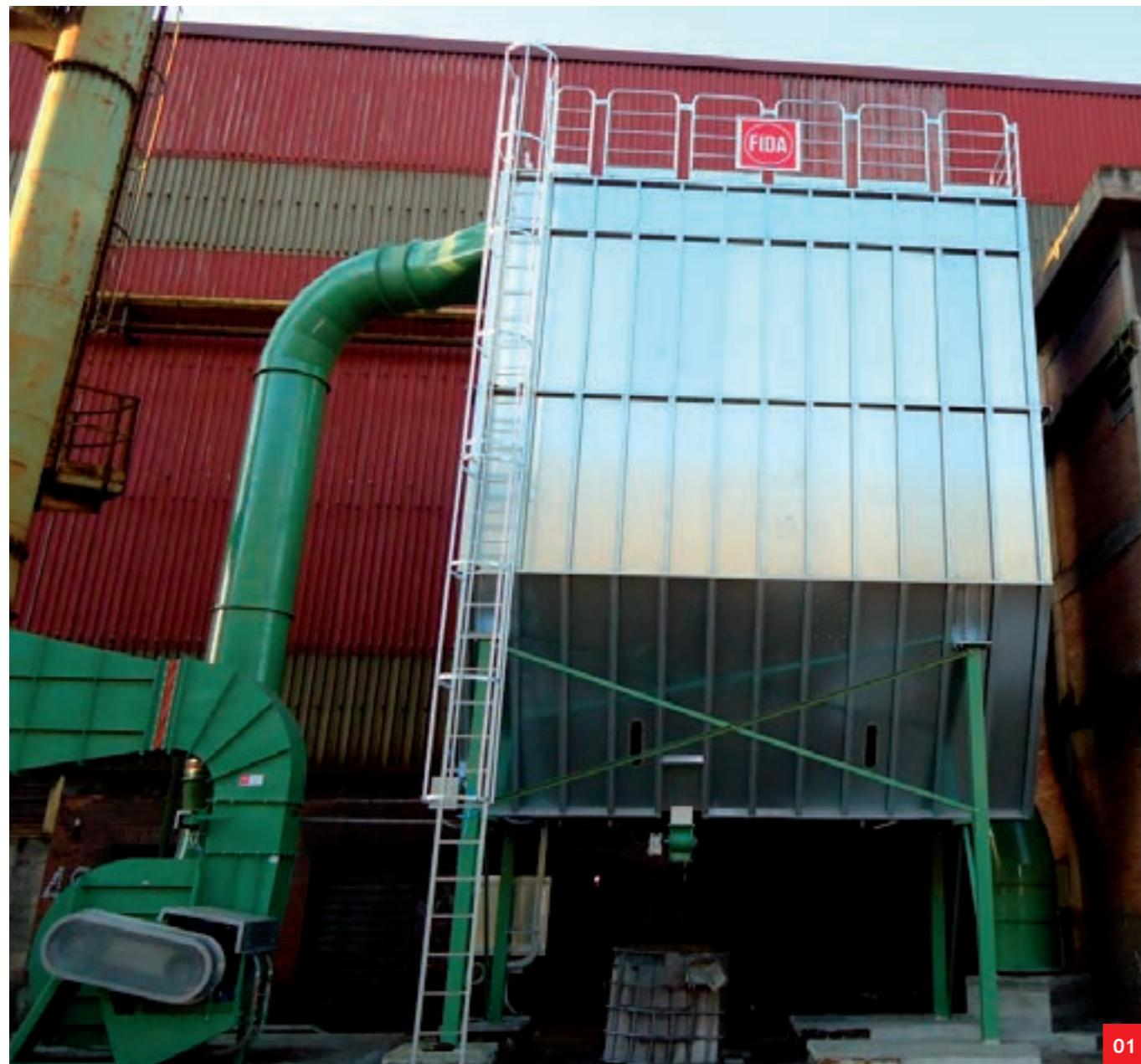
**01.** Filtro a pulizia automatica in controcorrente per abbattimento polveri di molatura barre di acciaio
