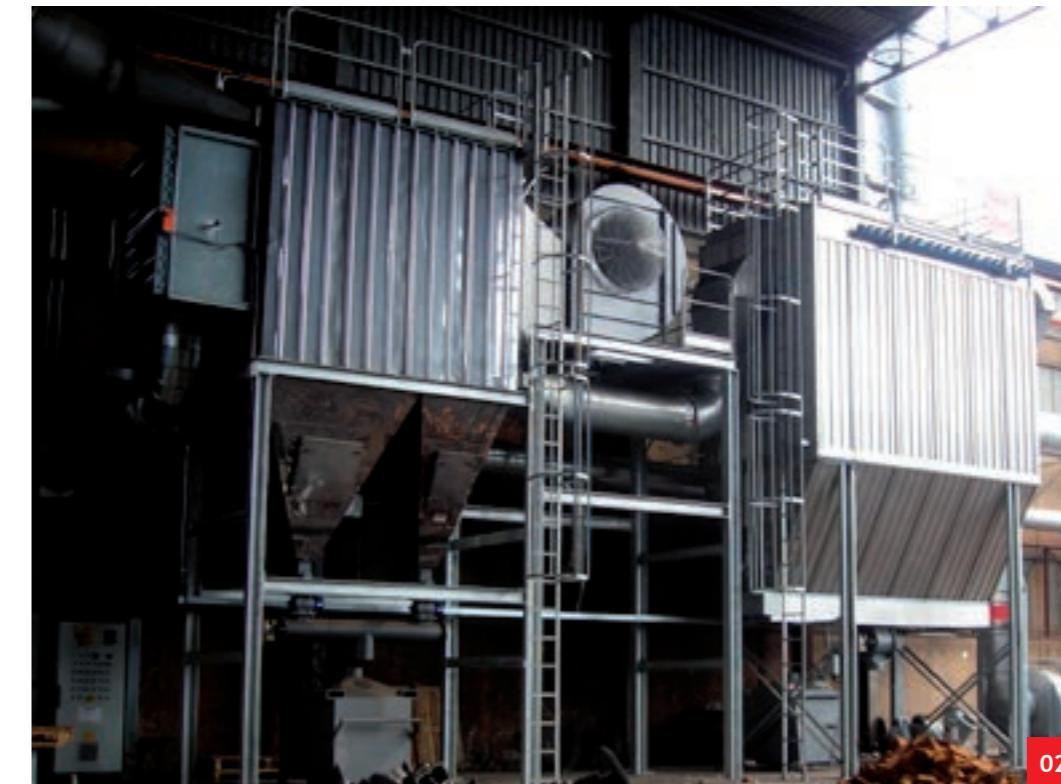
**02. 03.** Scambiatore di calore e filtro a pulizia automatica in controcorrente. Impianti coibentati
