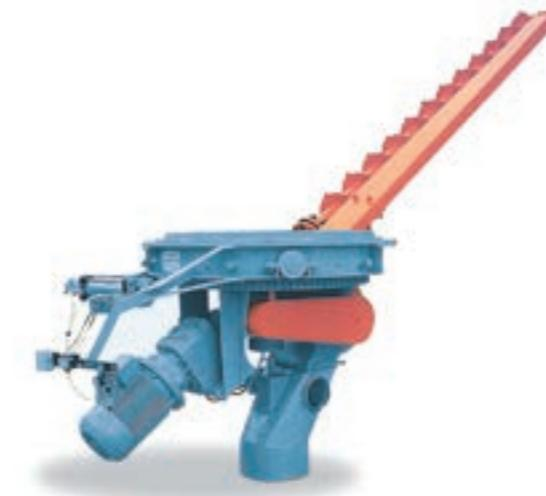
Estrattore a due coclee piane per alimentazione caldaia o scarico su autocarro.
