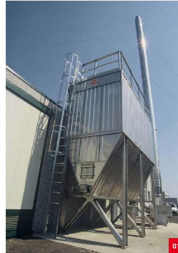
**01. 02.** Filtro con struttura in acciaio inox e coibentazione in lamierino inox.
