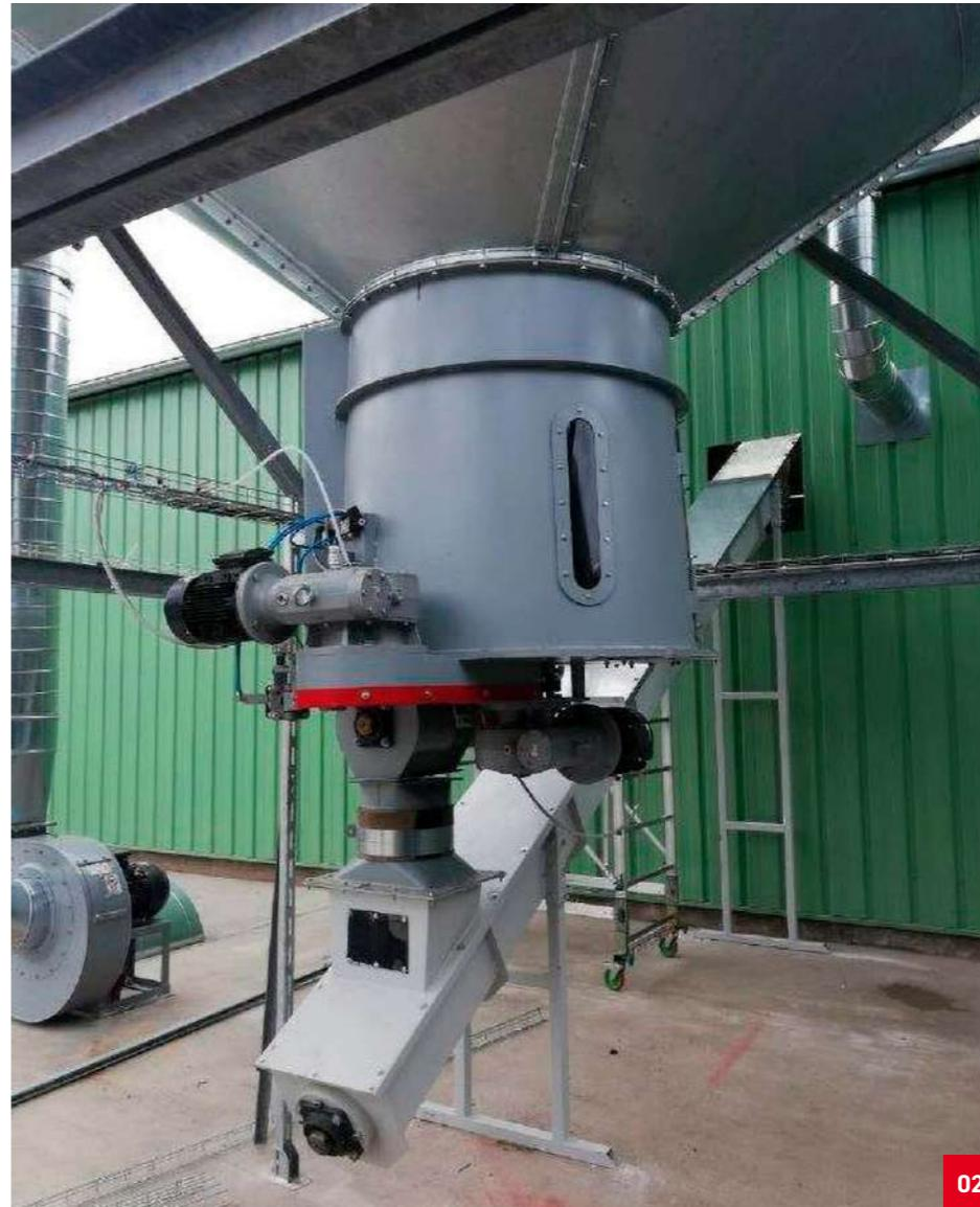
**01.** Estrattore a due coclee piane per alimentazione caldaia o scarico su autocarro.
