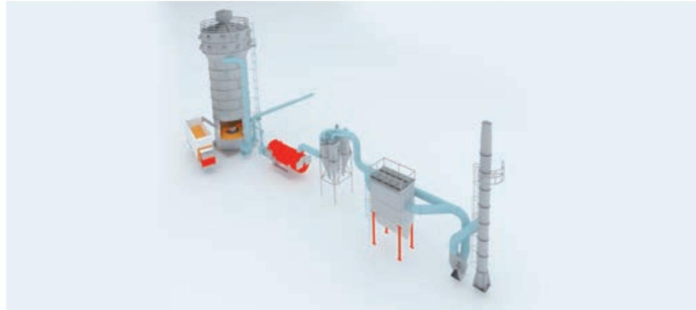
Sistemi dosaggio trucioli per alimentazione caldaia
