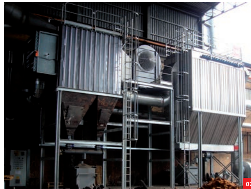
02. 03. Scambiatore di calore e filtro a pulizia automatica in controcorrente. Impianti coibentati Heat exchanger and self-cleaning filter. Both machines are insulated Теплообменник и фильтр с автоматической очисткой противотоком. Изолированное оборудование
